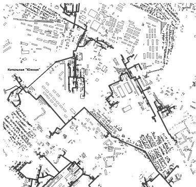
Рисунок 15 Схема теплоснабжения объектов от котельной "Южная" ООО "Городские энергетические сети"
