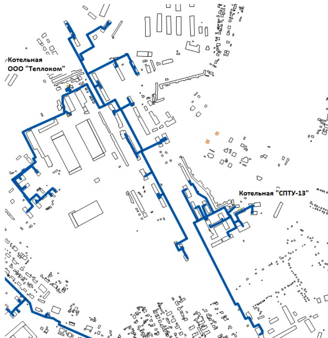
Рисунок 24 Схема теплоснабжения объектов от котельной «ООО «Теплоком», котельной «СПТУ-13» ООО «Городские энергетические сети»
